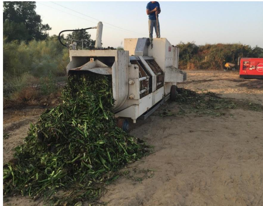
*Trituración mediante maquina tornillo sin-fin*
